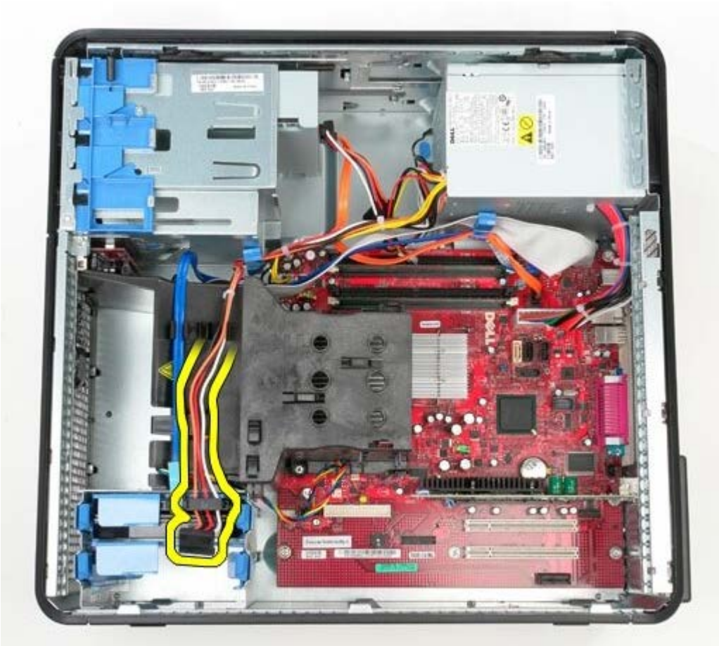
1 11 拔下光碟機電源線。
