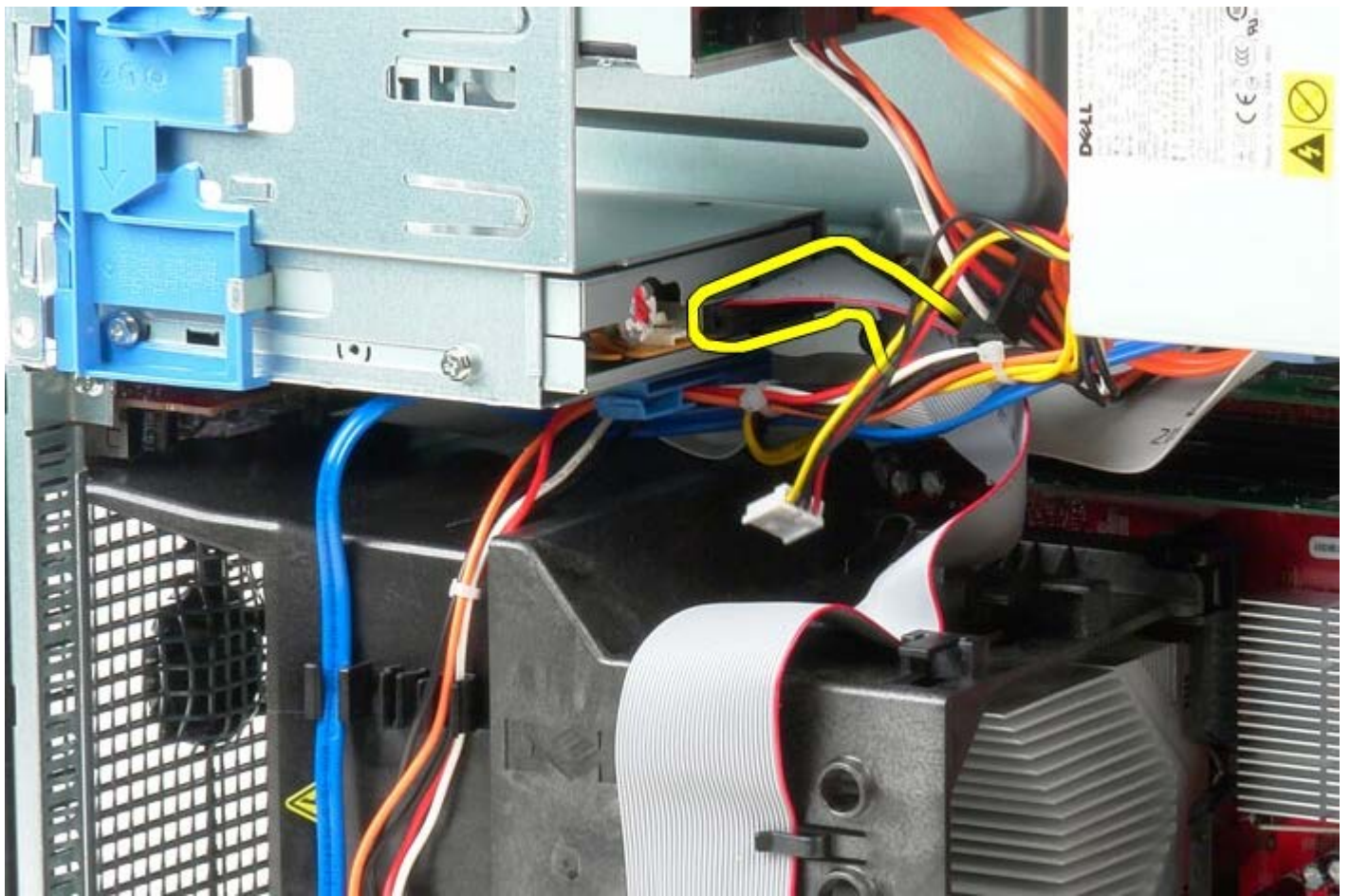
1 11 朝系統底座方向推動光碟機釋放門鎖並按住。
