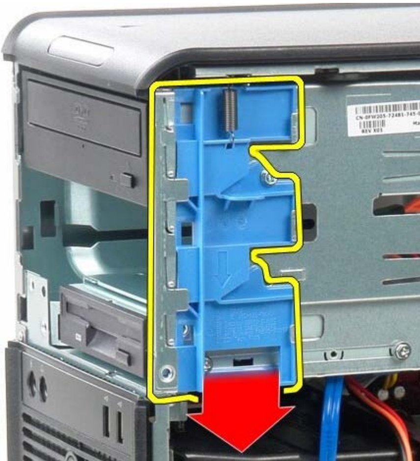
1 11 將光碟機推出系統。
