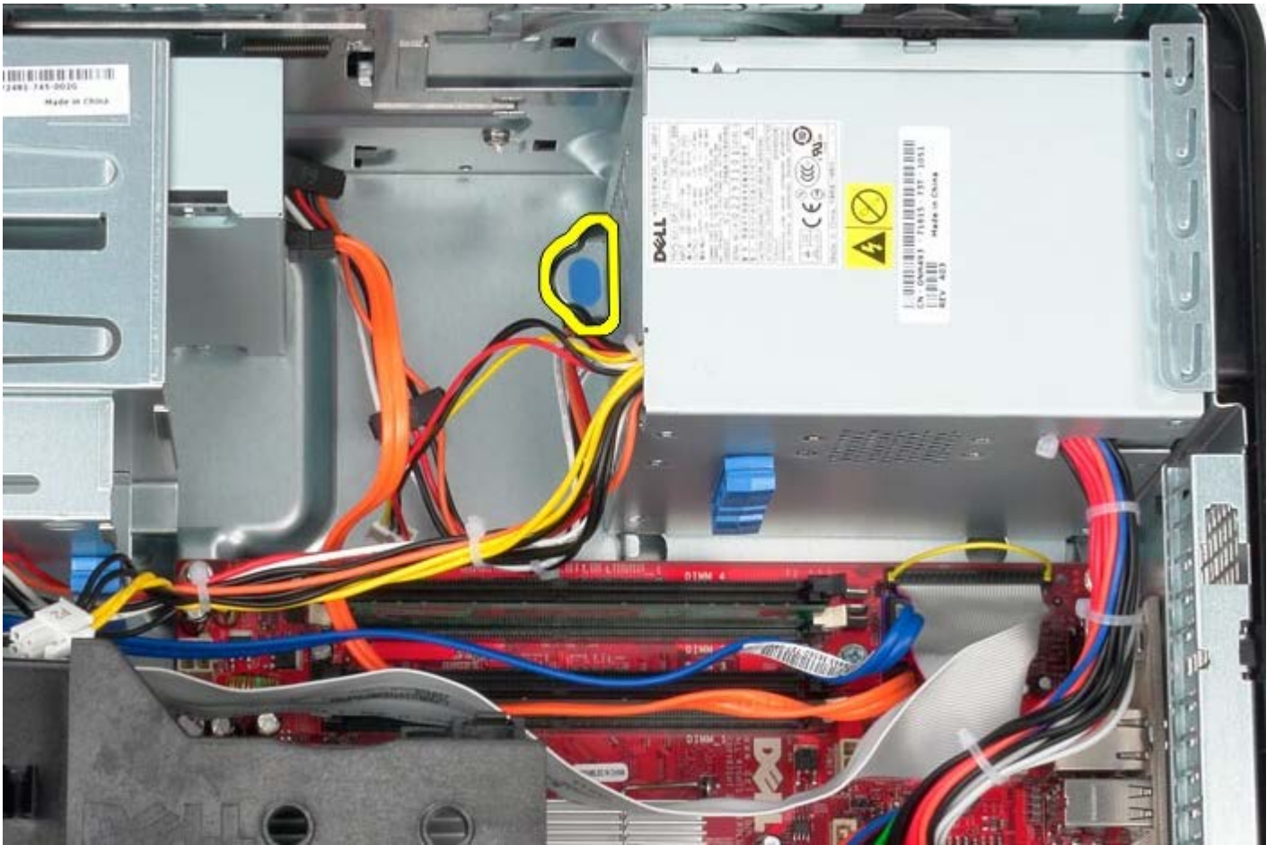
1 1 11 朝電腦正面推動電源供應器，然後從電腦提起並取出電源供應器。
