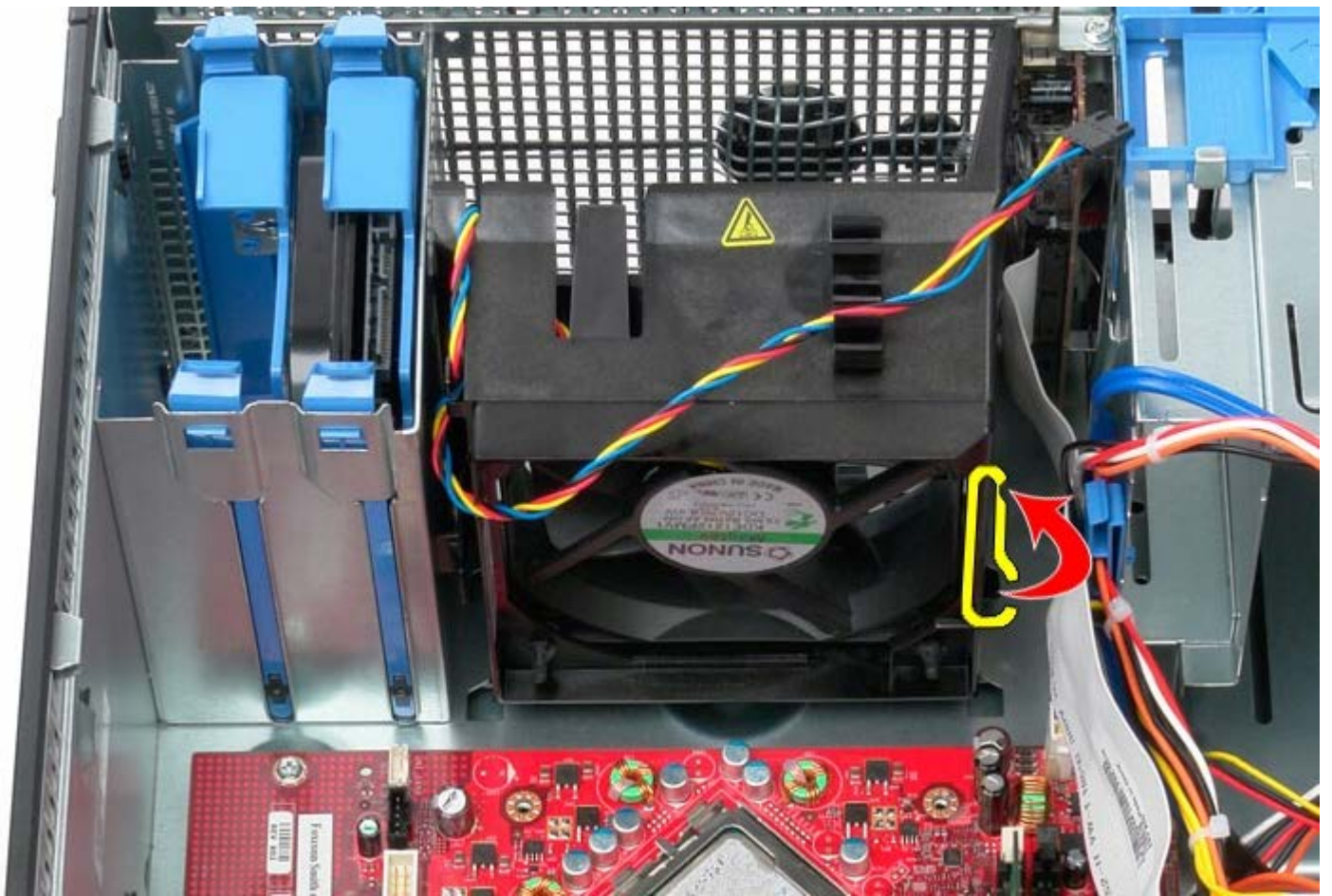
1 11 按壓最靠近電腦底座的處理器風扇固定彈片。
