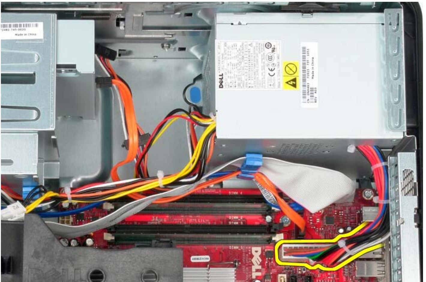
1 11 從電源供應器底座的纜線固定路徑卸下 IO 面板資料纜線。
