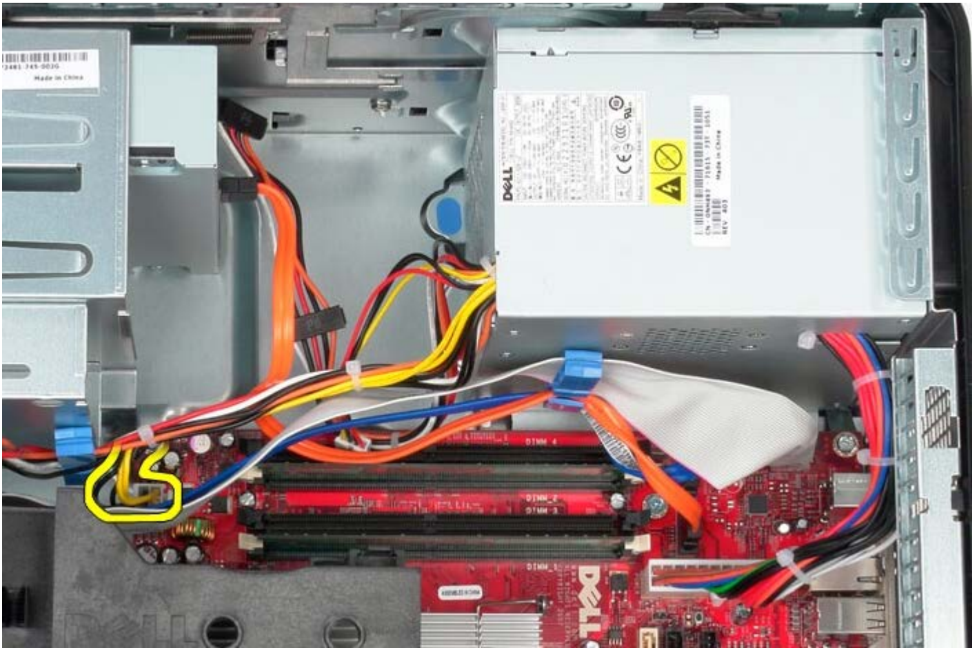
1 11 從主機板拔下主電源線。
