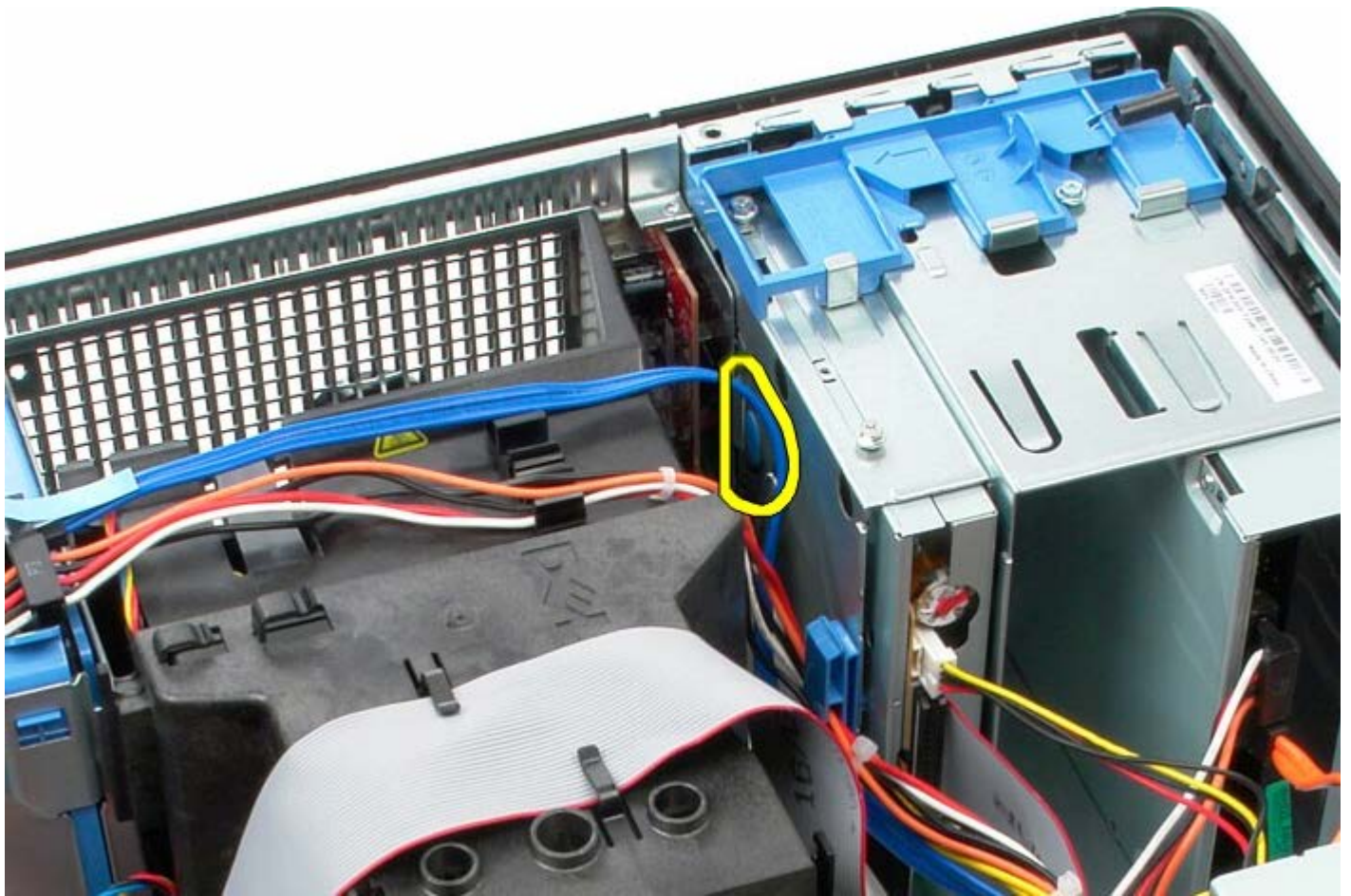
1 11 朝系統背面斜拉 IO 面板。
