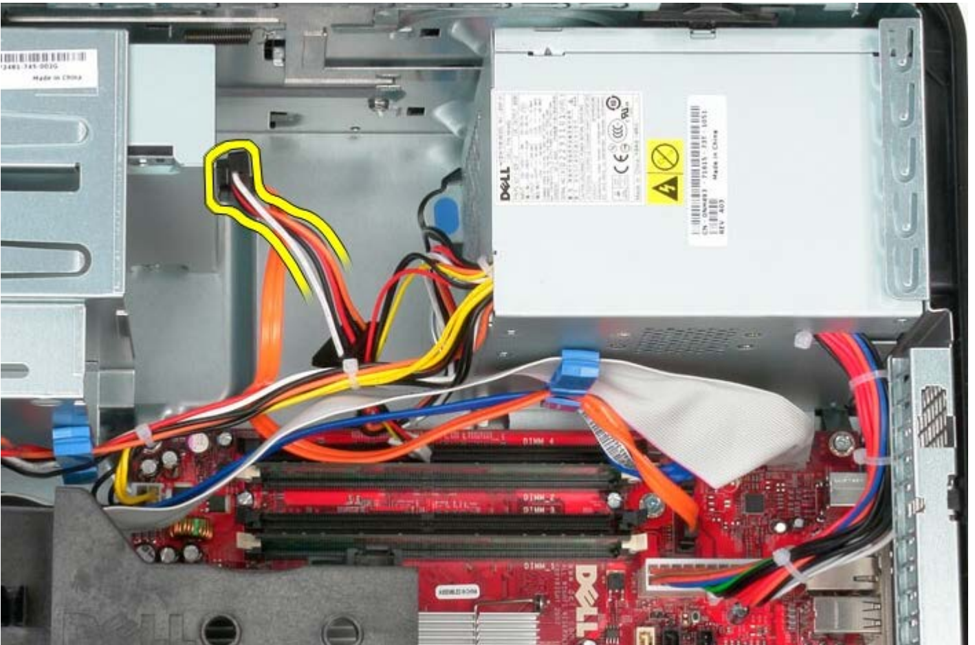
1 11 從主機板拔下處理器電源線。
