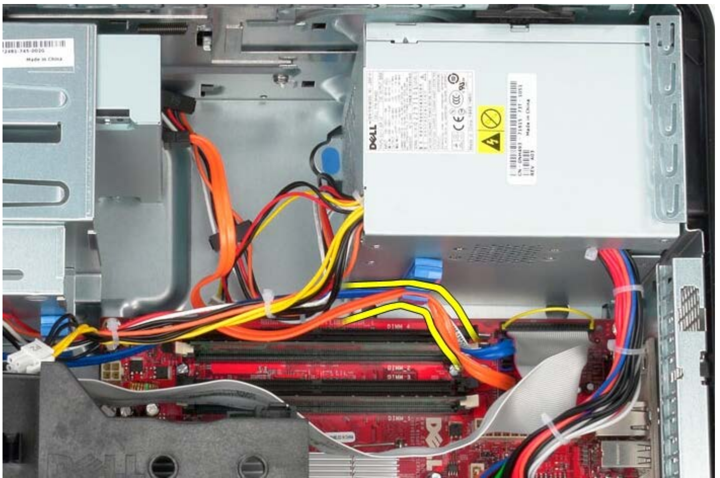
1 11 按壓將電源供應器固定至機箱的釋放門鎖。
