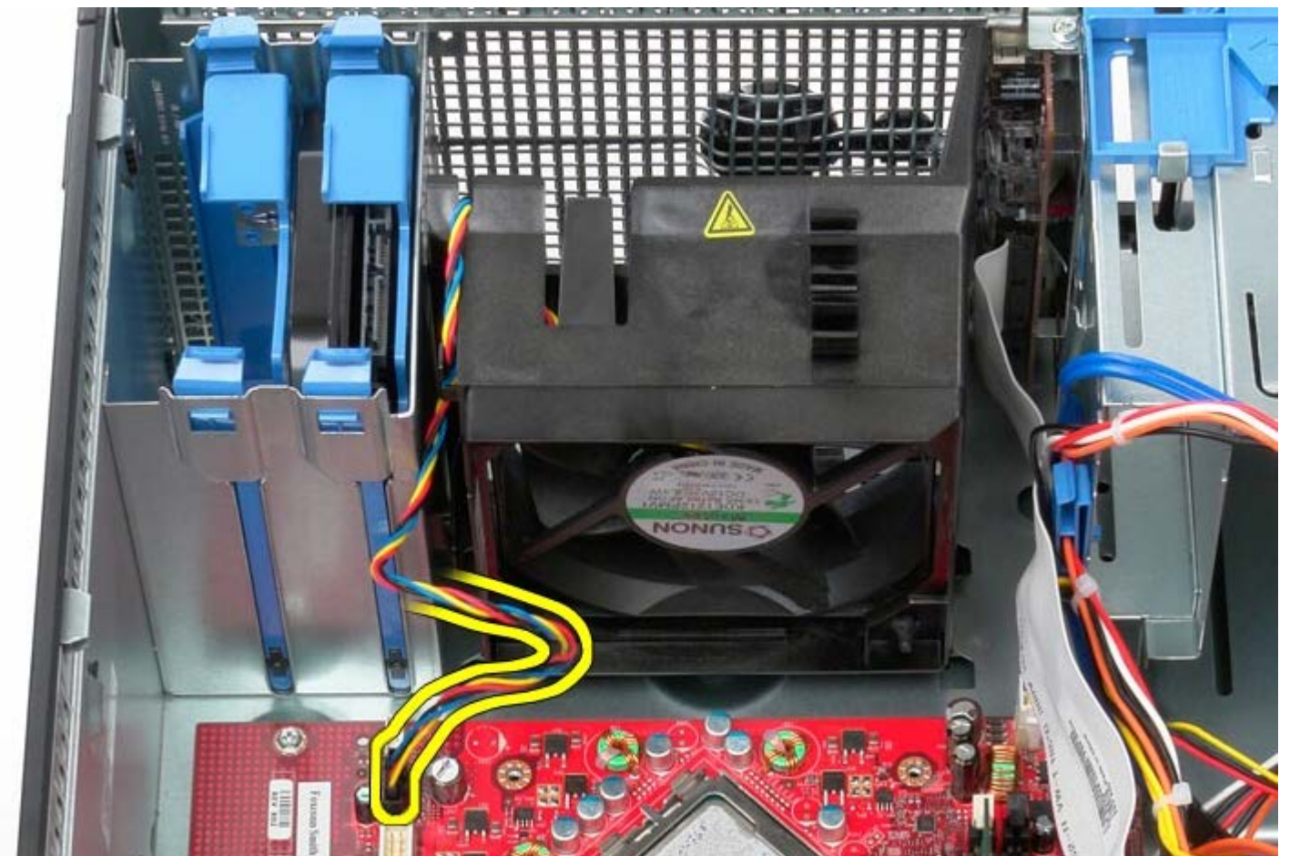
1 11 向上拉最靠近電腦頂部的處理器固定彈片。
